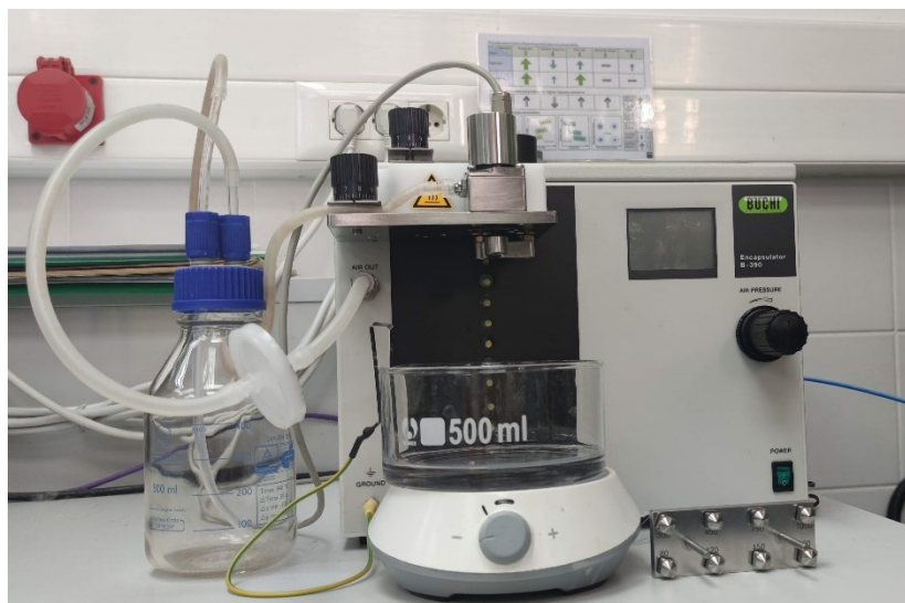
Slika 3.2 Uređaj za provedbu inkapsulacije metodom ionskog geliranja – Inkapsulator Büchi B-390
